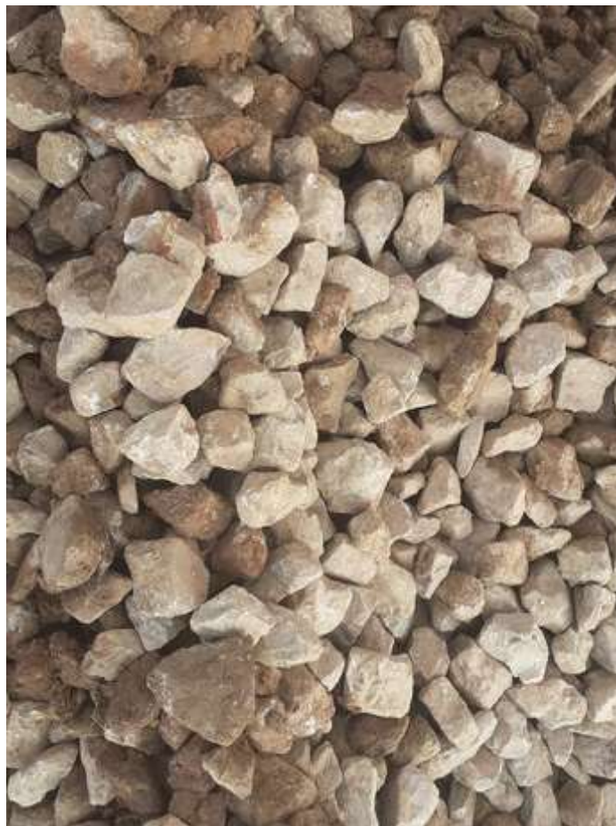
Exemple de matériaux constituant la couche drainante
